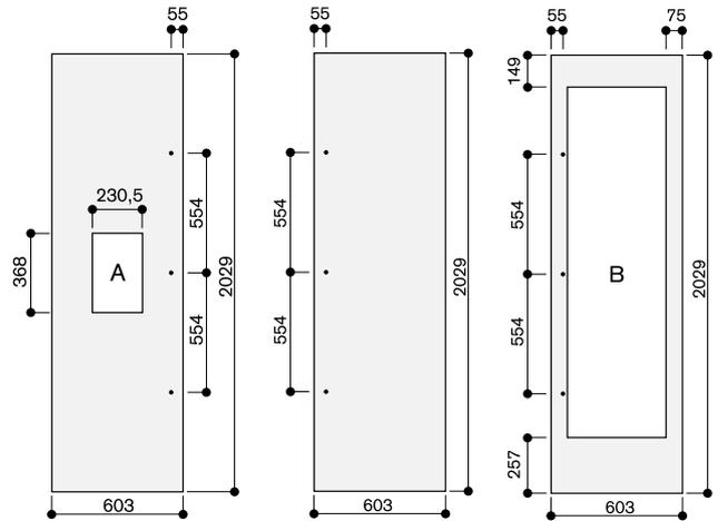
Die Türfrontdicke beträgt 19 mm. Die maximalen Türfrontmaße sind auf ein Spaltmaß von 3 mm ausgelegt, bezogen auf eine Einzelnische. A: Der Ausschnitt für die Eis- und Wasserausgabe ist horizontal und vertikal zentriert angeordnet. B: Breite der seitlichen Rahmenteile der Türfront kann zwischen 65 mm und 82 mm betragen.
