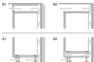
A: Lufteintritt ≥ 200 cm<sup>2</sup>; Lüftungsmöglichkeiten A1 oder A2
