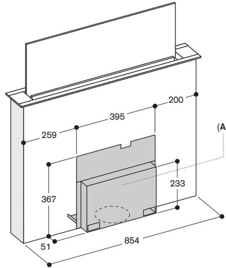
A: Der Zugang zur kompletten Abdeckung muss auch nach der Montage gewährleistet sein
