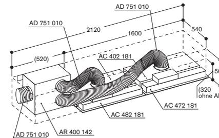
**AC 402 Deckenbefestigung und Position Stützen NW 150**
