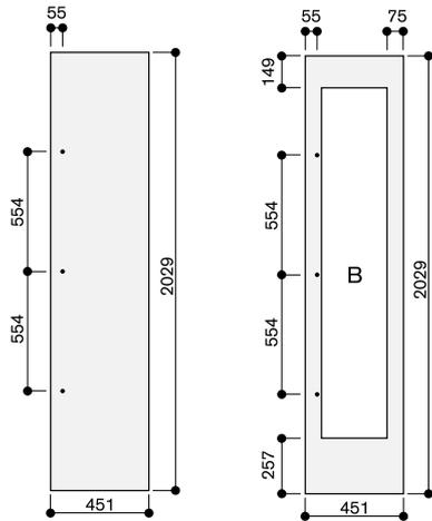
Die Türfrontdicke beträgt 19 mm. Die maximalen Türfrontmaße sind auf ein Spaltmaß von 3 mm ausgelegt, bezogen auf eine Einzelnische. B: Breite der seitlichen Rahmenteile der Türfront kann zwischen 65 mm und 82 mm betragen.
