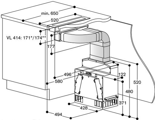
\* aufgesetzter Einbau
